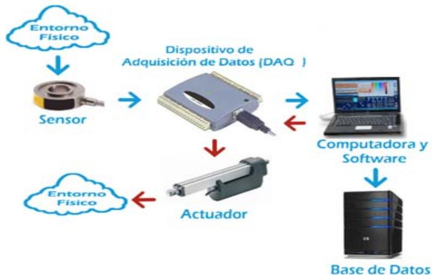
Figura 2: Esquema de adquisición de datos
