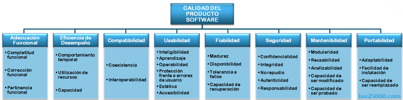
Figura 1-3. Modelo de calidad del producto de la ISO 25010 (Oficina Nacional de Normalización 2016)
