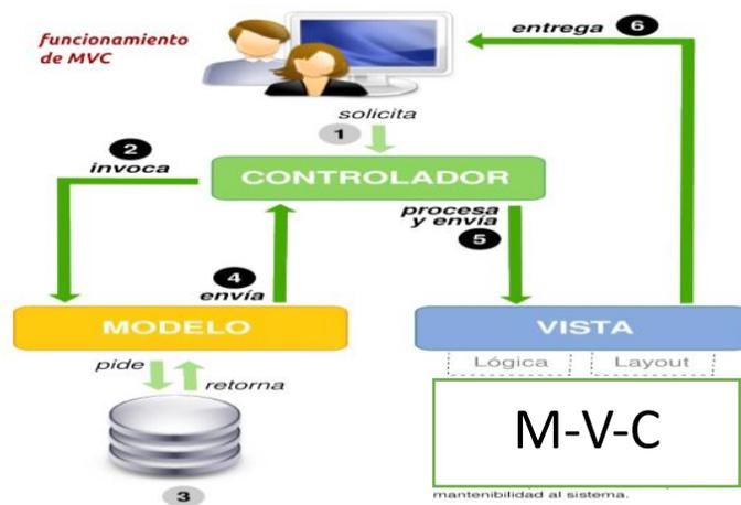
Figura 3: Funcionamiento del patrón modelo-vista-controlador
