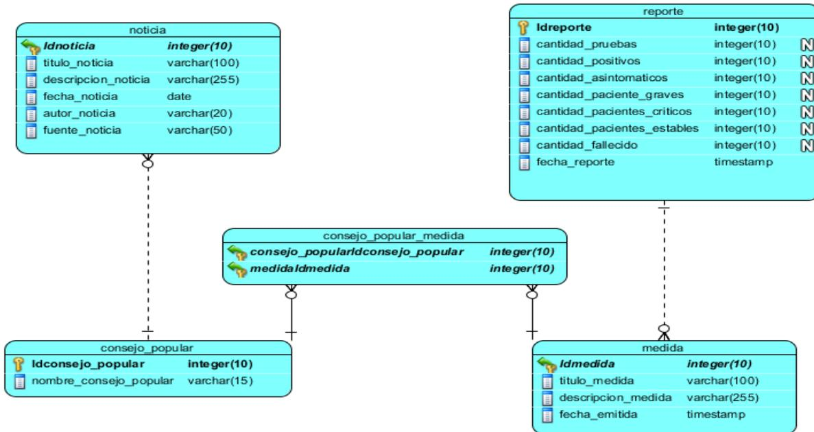
Ilustración 4: Diagrama de Modelo de Datos
