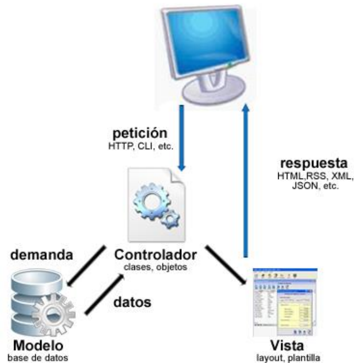
Figura 2.2. Patrón arquitectónico Modelo-Vista-Controlador
