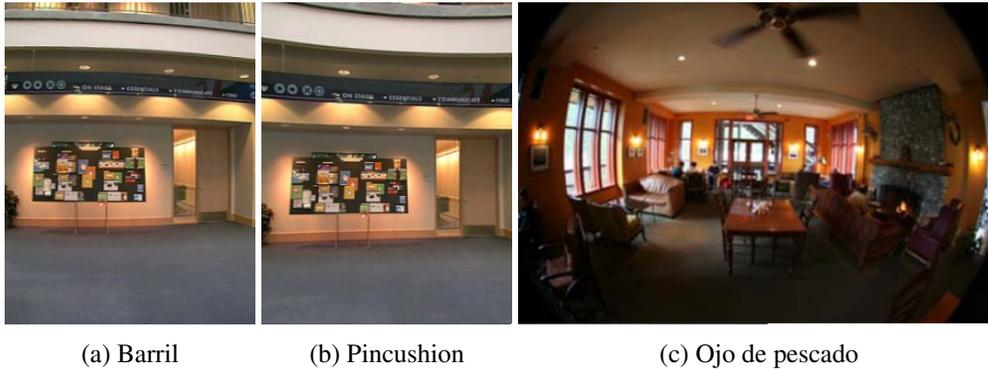
Figura 1.7. Distorsiones geométricas (SZELISKI, 2010).
