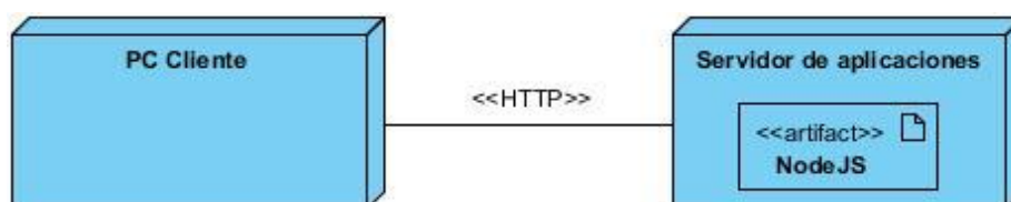
Figura 21 Diagrama de despliegue
