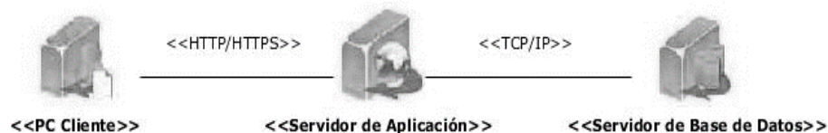
Figura 4 Diagrama de Despliegue. (Fuente: Elaboración propia)
