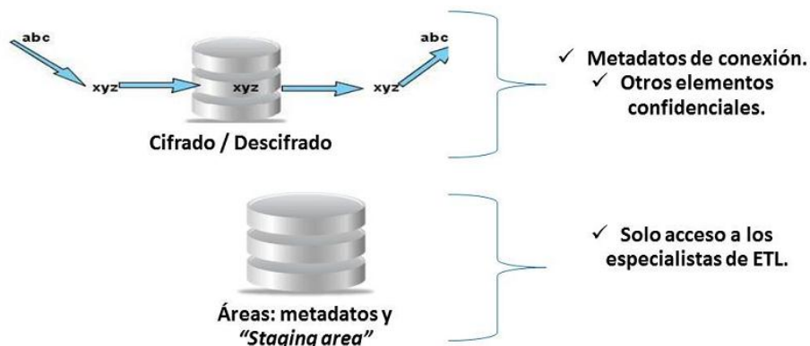
Figura 23: Ejemplos de mecanismos de seguridad para el subsistema Procesos ETL. Elaboración propia.
