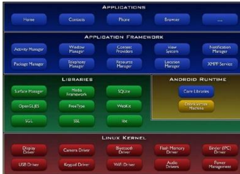
Figura 2: Arquitectura de Android. Fuente: (Android Inc, 2016)
