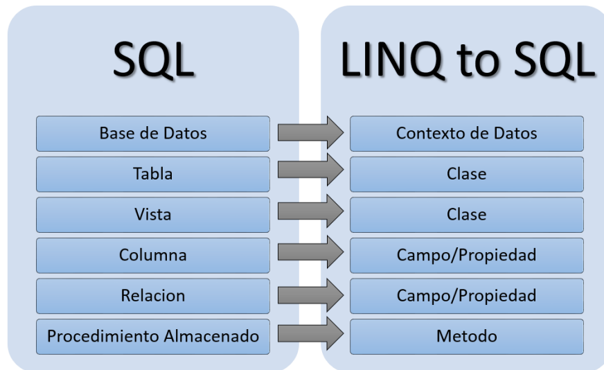
Figura 5 Correspondencia de los elementos de SQL a LINQ To SQL (Elaboración propia)
