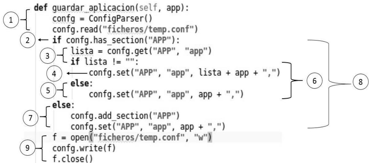
Figura 17. Procedimiento guardar aplicación del RF8 Adicionar aplicación
