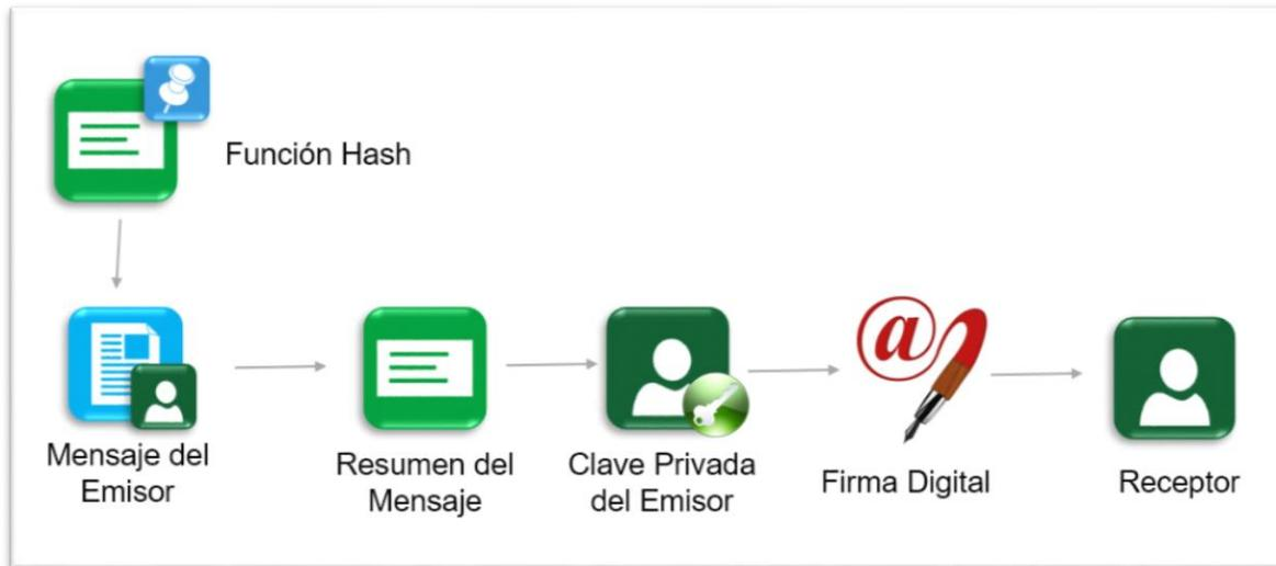
**Figura 6:** Proceso de Verificar Firma de un Documento Digital. (*Elaboración propia*)
