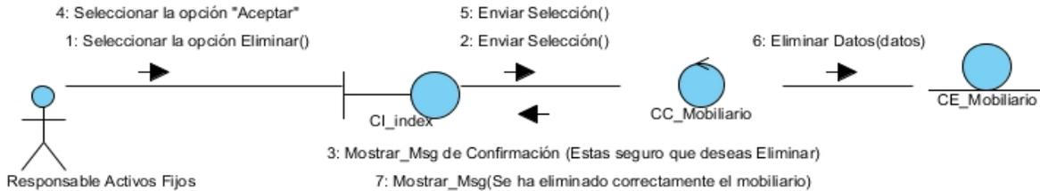
Figura 2.6 Diagrama de colaboración del CU Gestionar Mobiliario (Eliminar Mobiliario).
