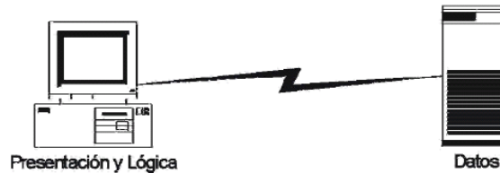
Figura 2: Arquitectura en dos capas
