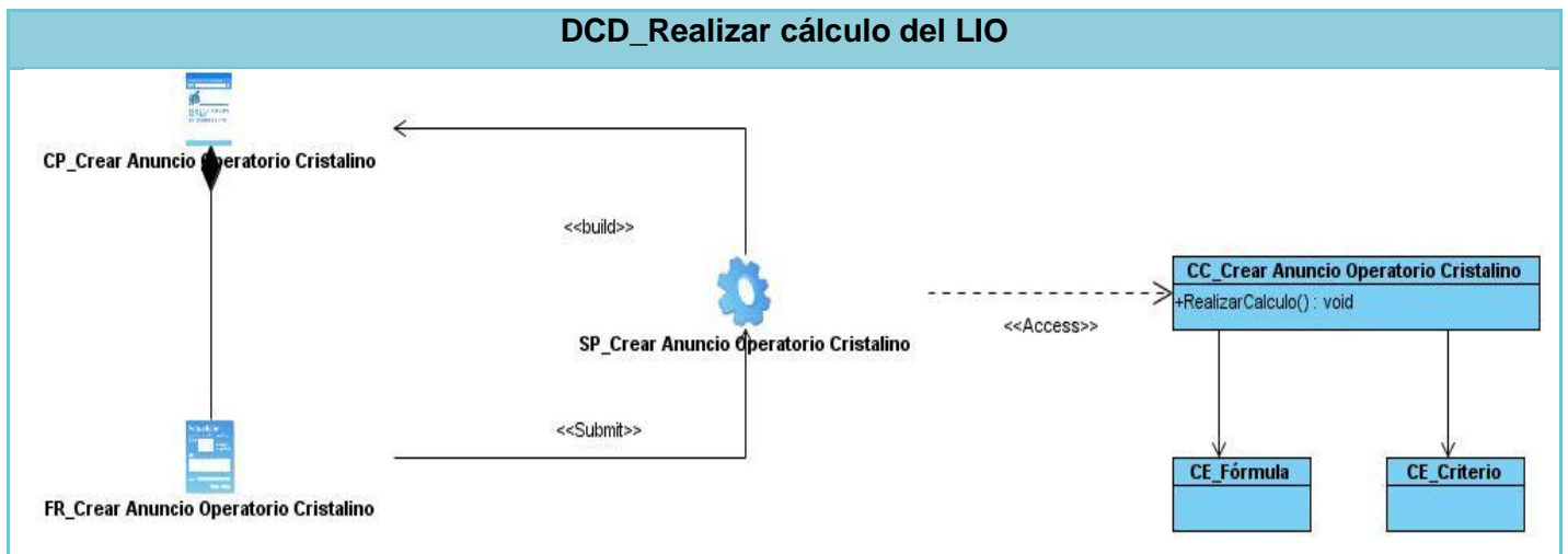
Figura 3.5 Diagrama de clases del diseño: Realizar cálculo
