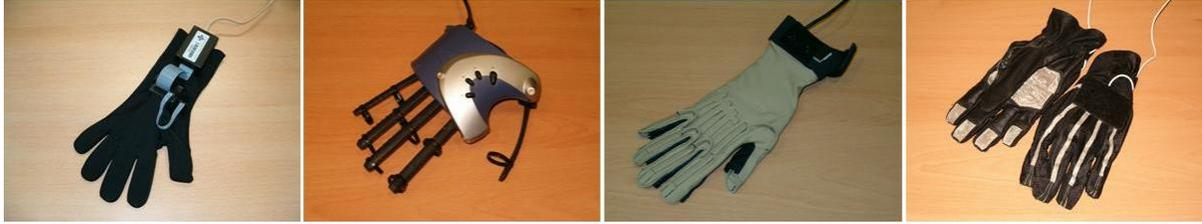
Figura 1.8. Diferentes modelos de guantes ofrecen distintas tecnologías y número de sensores.
