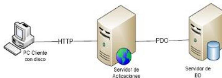
**Figura 10:** Diagrama de despliegue de escenario para PC cliente con disco.
