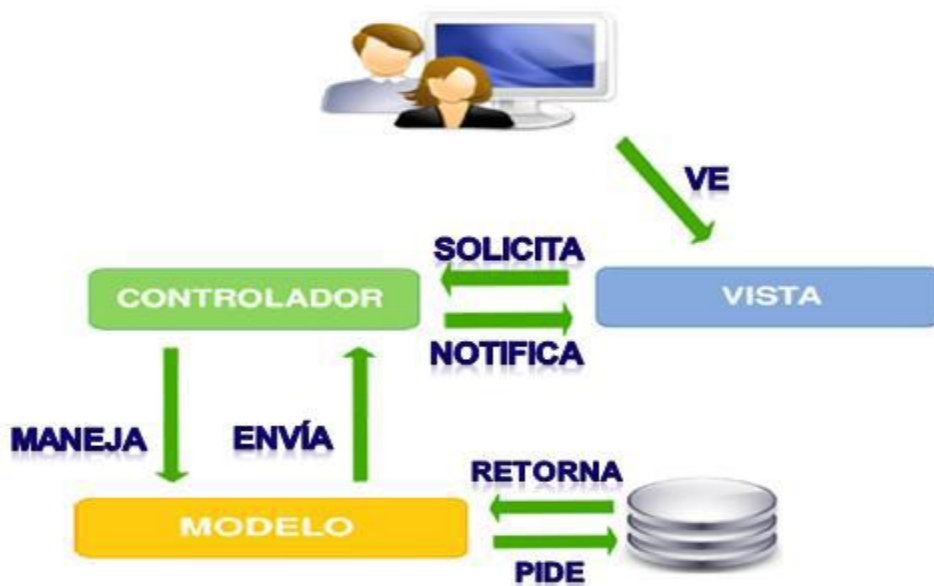
Figura 1 Estilo arquitectónico Modelo-Vista-Controlador
