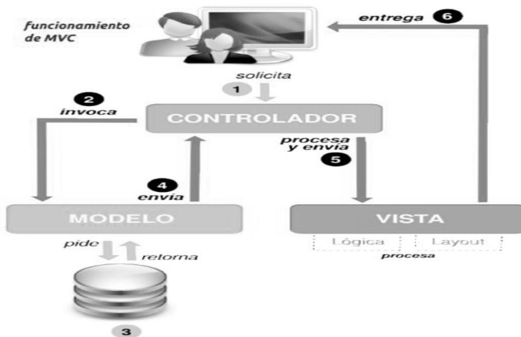
Figura 3: Funcionamiento del patrón de arquitectónico MVC
