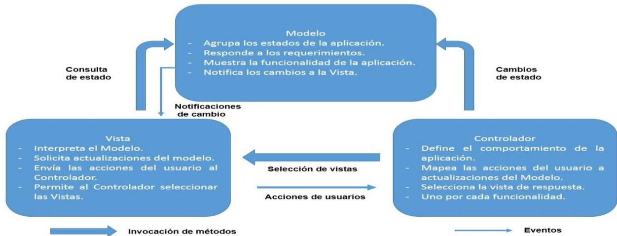
Figura 6: Estructura del patrón MVC.
