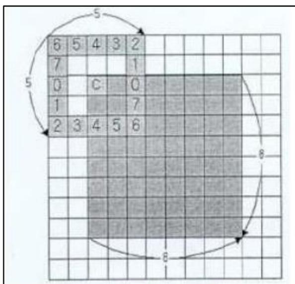
Figura 37 Filtro para determinar el contraste direccional.
