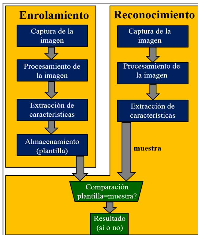
Figura 34 Modos de funcionamiento de un SAID.
