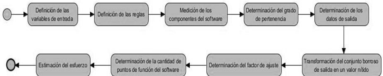
Figura 9. Algoritmo para estimar el esfuerzo a partir de puntos de función utilizando 2-tuplas
