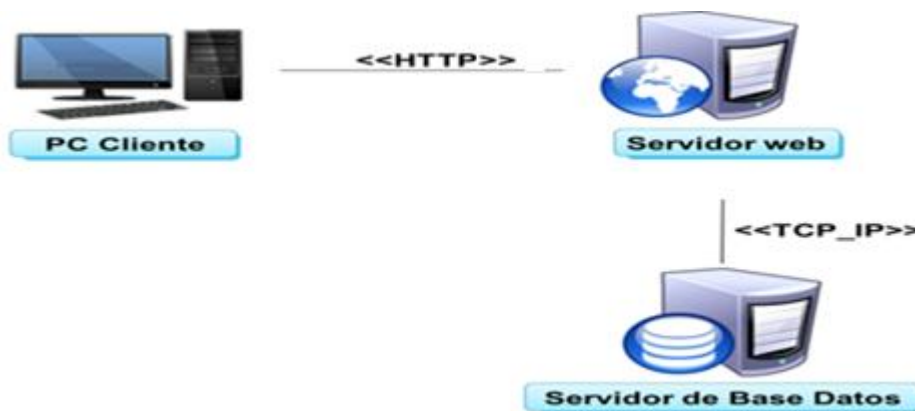
Figura 19. Diagrama de Despliegue.
