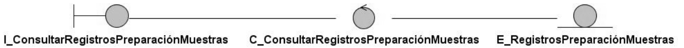
Figura 9. Diagrama de Clases de Análisis. CU Consultar Registros de Preparación de Muestras.
