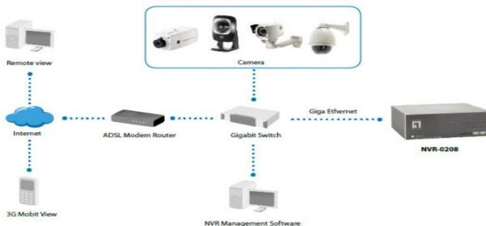
**Figura 5** Esquema de un sistema que incluye un NVR.
