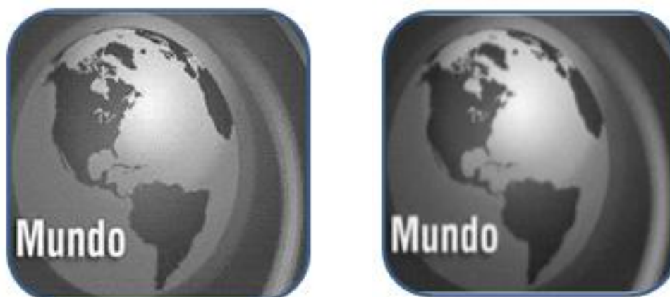
Fig.16: a) Imagen en escala de grises b) Imagen después del filtro Gaussiano
