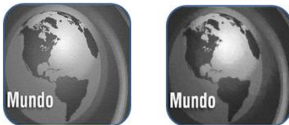
Fig.17: a) Imagen en escala de grises b) Imagen después del filtro Mediana
