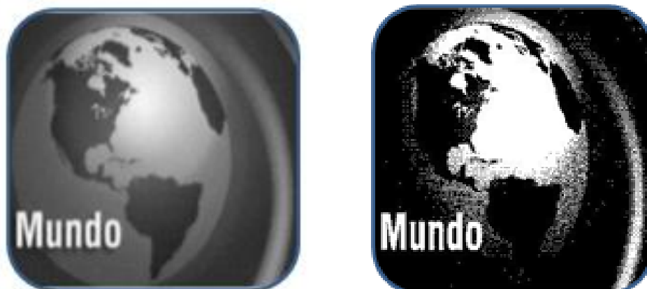
Fig.24: a) Imagen después del filtro Gaussiano b) Imagen después del operador ImageFilter
