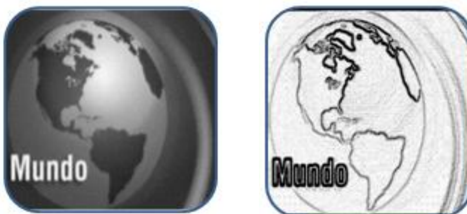
Fig.19: a) Imagen después del filtro Gaussiano b) Imagen después del operador Sobel
