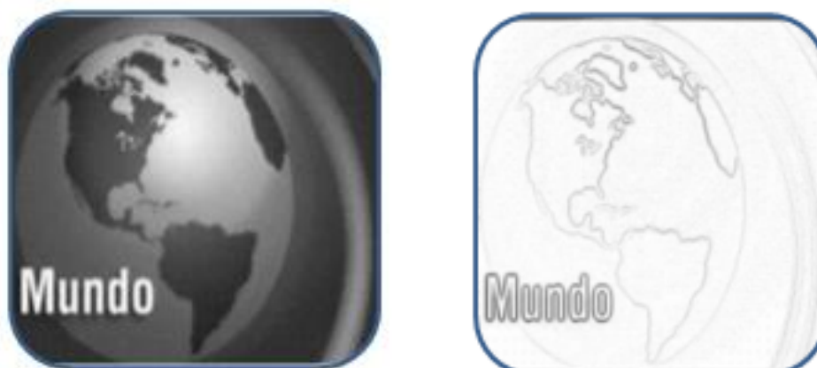
Fig.23: a) Imagen después del filtro Gaussiano b) Imagen después del operador Robert
