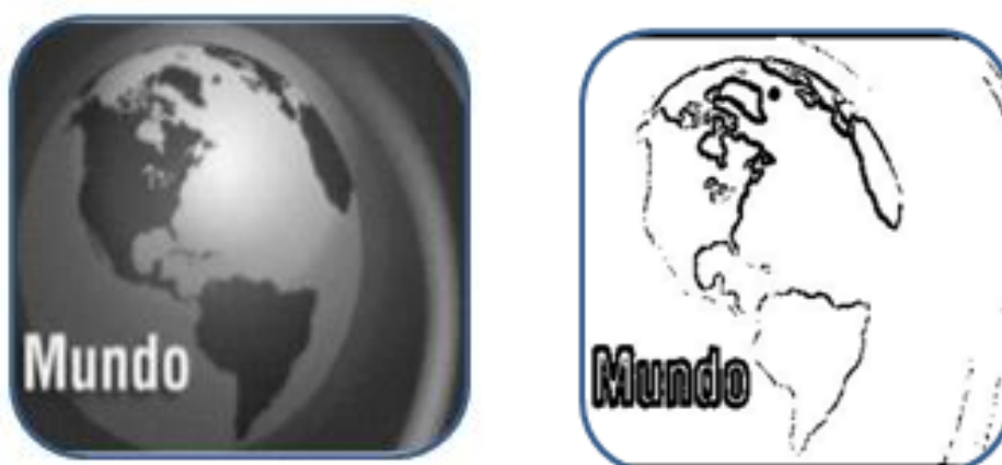
Fig.22: a) Imagen después del filtro Gaussiano b) Imagen después del operador Canny
