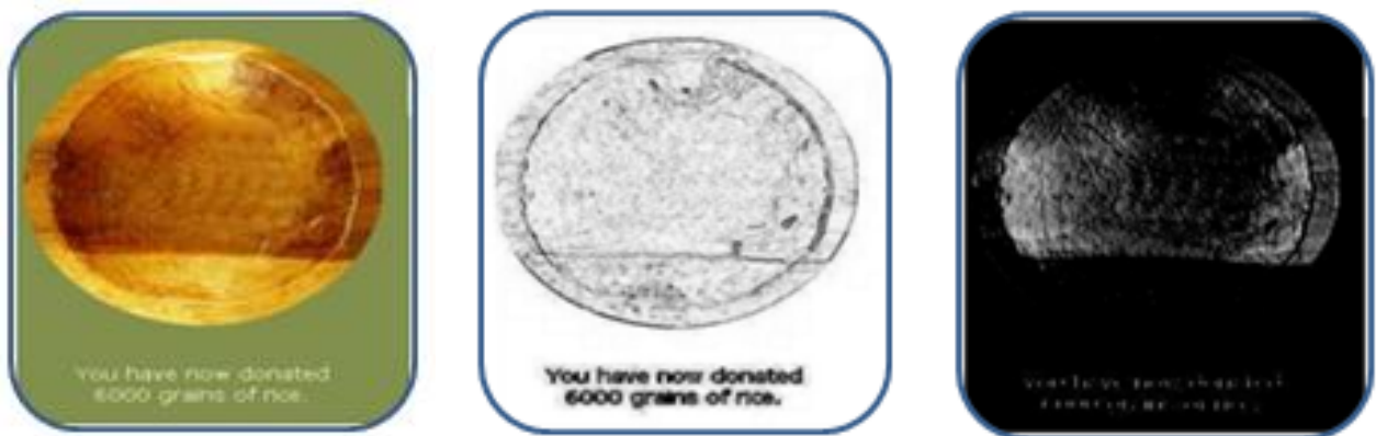
Fig.7. a Imagen original b) Detector de contorno de Prewitt c) Detector de contorno de Sobel
