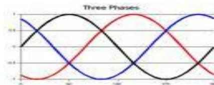
**Figura 1** Forma de onda de sistemas trifásicos.
