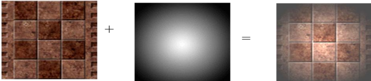
Fig: 2 Proceso de Multitexturizado: a) Textura original b) Mapa de luz c) Resultado final
