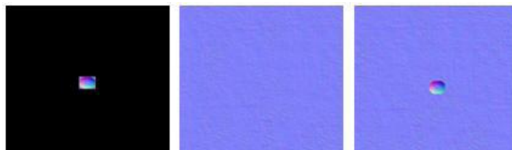
Fig: 25 Actualización del normal map solo en los texels deformados.
