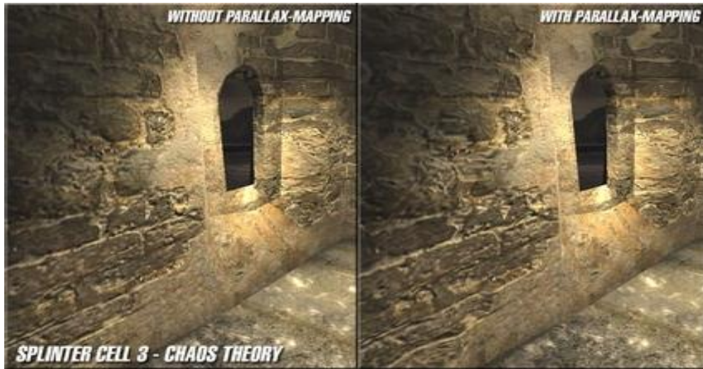
Fig: 6 Efecto conseguido por el Parallax Mapping en el juego Splinter Cell 3 - Chaos Theory:
