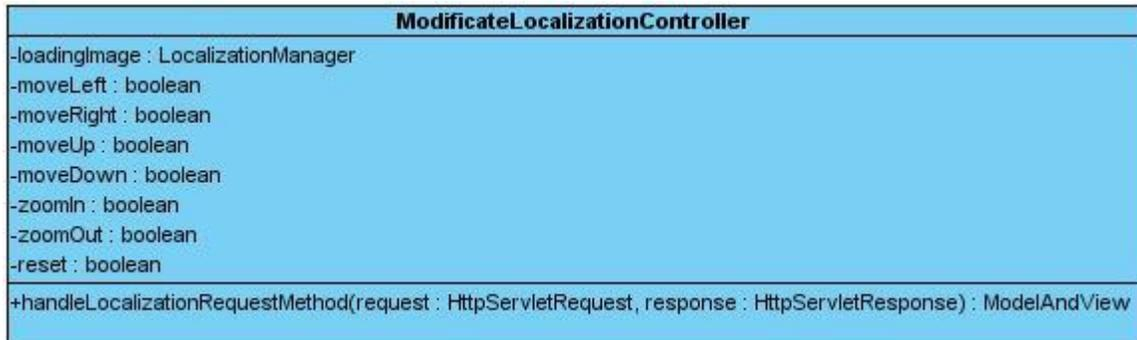
Figura 3.15: Clase ModificateLocalizationController.
