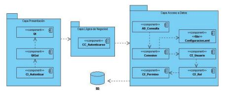
Figura. 13: Diagrama de Componentes Autenticar Usuario.
