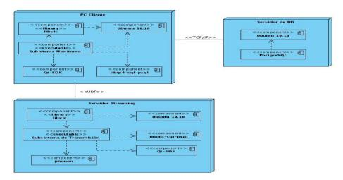
Figura. 16: Modelo de Despliegue.
