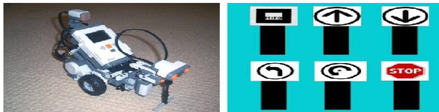
a) Robot Lego Mindstorms NXT. b) Paletas con los iconos virtuales.
