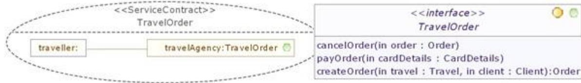
**Figura 16.** Modelado de un Contrato de Servicios con Interfaz del Proveedor.
