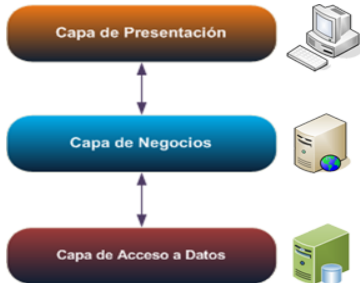
Fig. 3: Arquitectura de la solución. Fuente: Elaboración propia.
