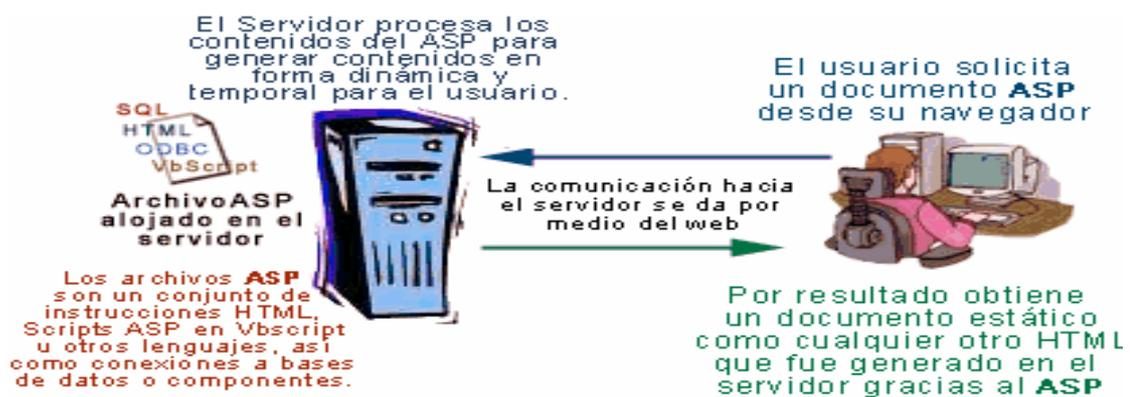
Figura 4. Funcionamiento del ASP.
