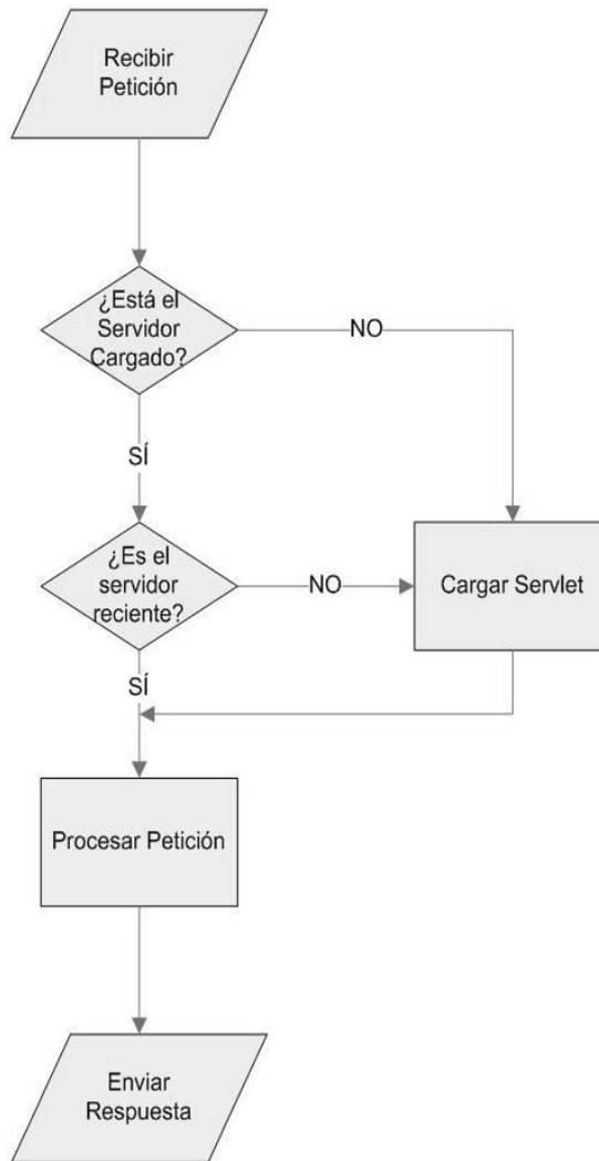
Figura 2.3.1.1: Funcionamiento de un servlet
