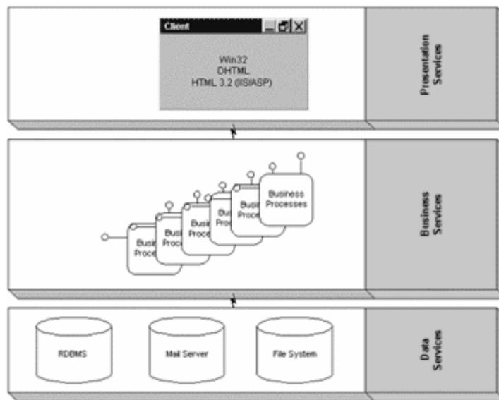
Figura 1.9.1.2.1: Elementos del patrón 3 capas, subconjunto del estilo N capas
