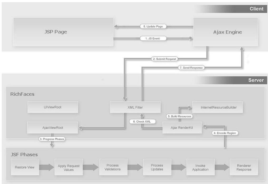
Figura 3.3.1: Funcionamiento de una petición AJAX con Rich Faces (24)
