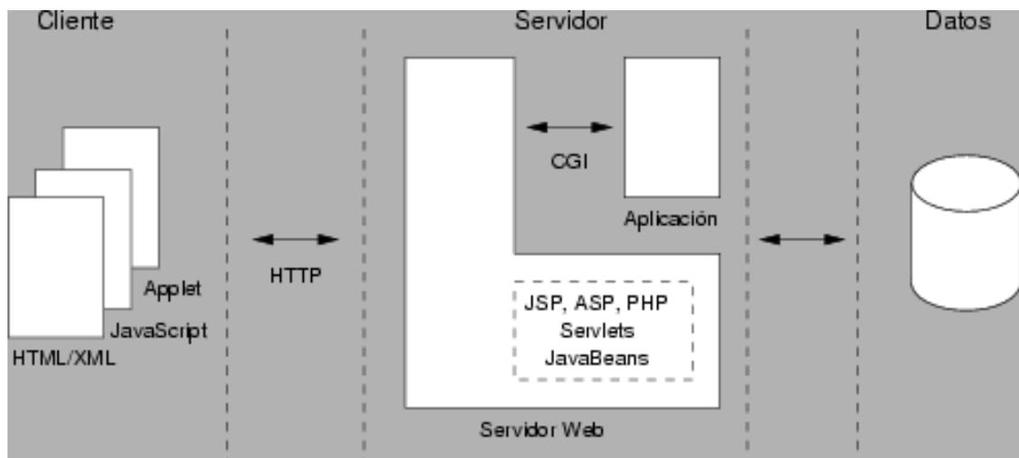
Figura 1.4.1: Elementos de una aplicación Web
