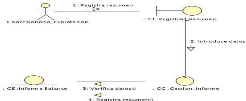
Figura #30: Diagrama de Secuencia del CU: "Gestionar Resumen"
