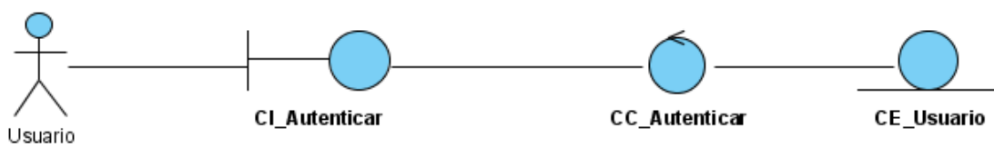
Figura 2.1 Diagrama de clases del análisis del CU Autenticar Usuario
