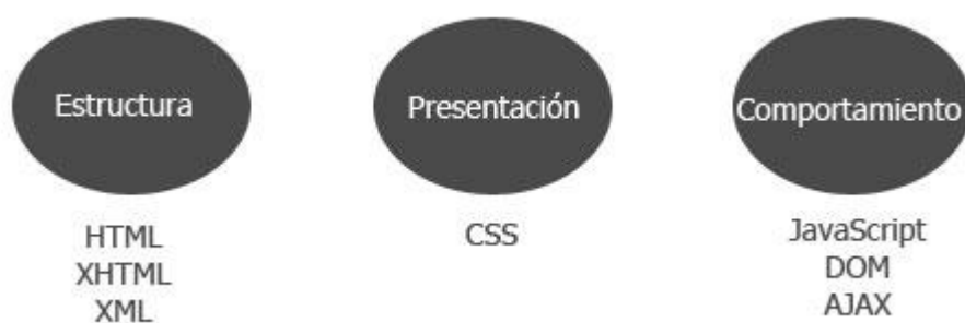
Figura 2.1 En esta imagen se puede comprobar cómo los estándares Web separan cualquier documento en tres componentes diferentes: estructura, presentación y comportamiento.
