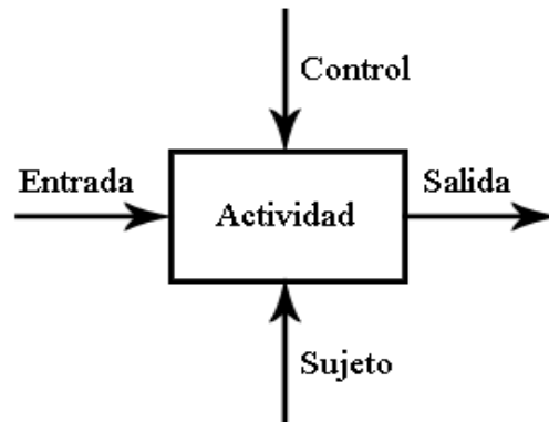
Figura 2: Elementos gráficos para la construcción de diagramas IDEF 0.
