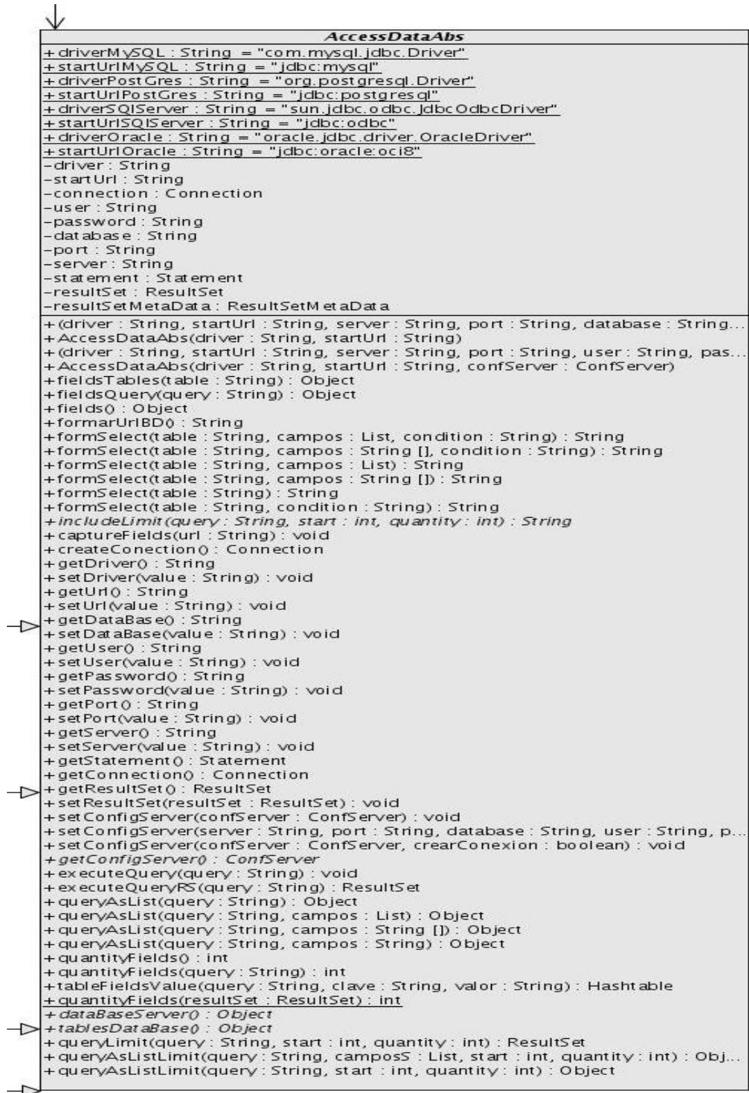
Figura 4.6. Diagrama de clases del diseño para Configurar conexión a base de datos: inferior derecho.
