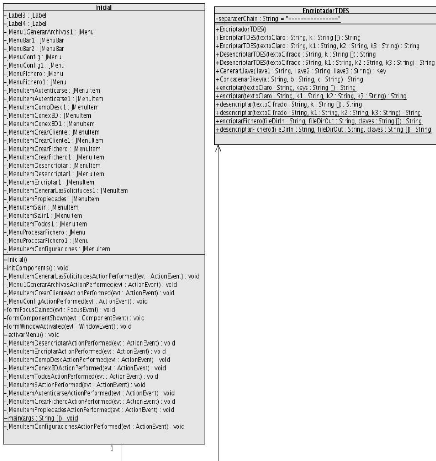
Figura 4.1. Diagrama de clases del diseño para Generar archivos con datos: superior.
