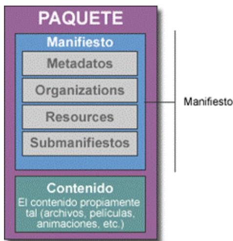
**Fig 2.** Estructura de un paquete IMS Content Packaging
