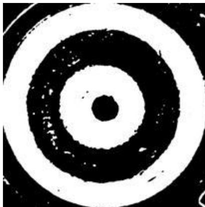
Fig. 4.6 Imagen binarizada invertida para localizar la marca de la aguja percutora.
