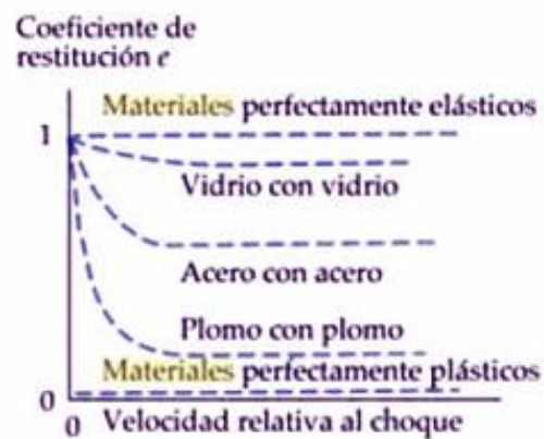
Figura 16: Relación del coeficiente de restitución y la velocidad relativa al choque (26).
